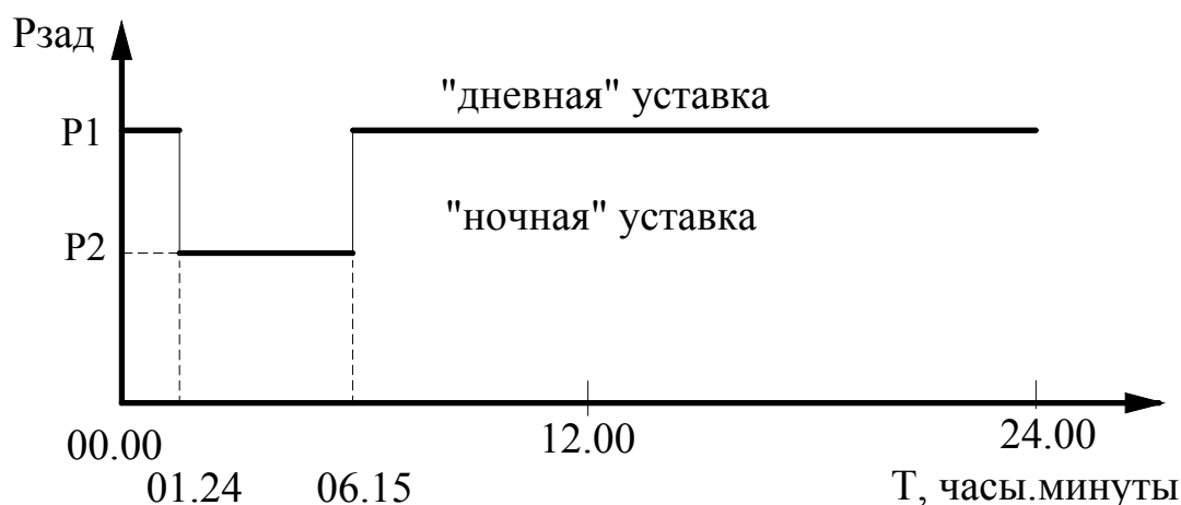
Рис. 5.1. Работа системы управления по двум уставкам заданного давления
