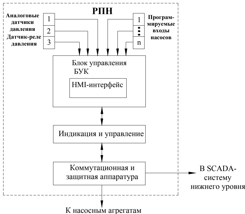
Рис. 5.2. Структурная схема РПН при отказе ПЧ
